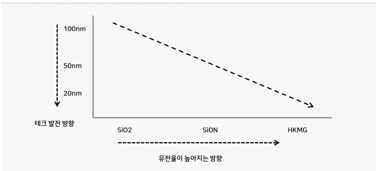
그림 6. 트랜지스터 테크놀로지 발전에 따른 게이트 옥사이드 재질 변화
