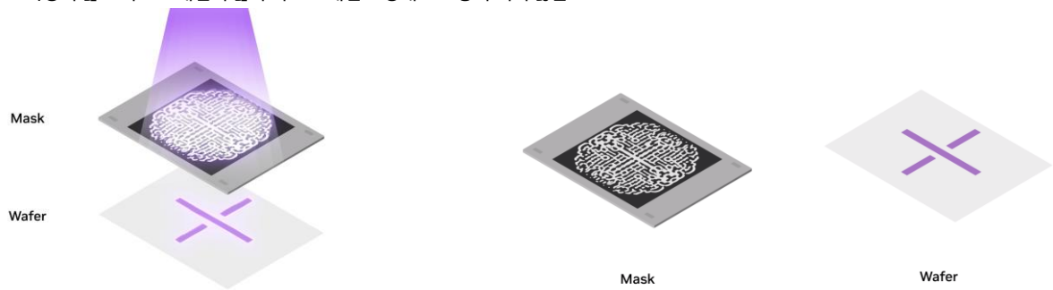
그림 6. EUV 파장이 짧고 마스크 패턴이 얇아 마스크 패턴 모양대로 노광이 되지 않음
